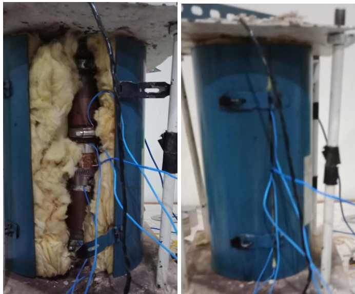
Gambar 3. 12 Gambar Pemasangan Spesimen pada Alat Uji
