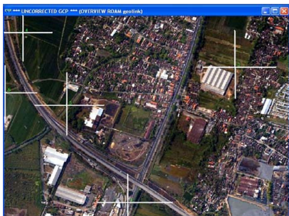
Gambar 6. Sebaran titik GCP Foto Udara Format Kecil
