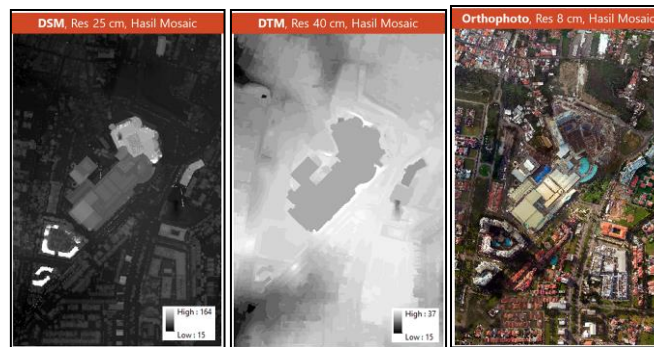
Gambar 2. Data raster yang digunakan dalam penelitian ini berupa DTM, DSM, dan foto udara. Kotak berwarna putih pada kanan bawah menunjukkan legenda atau nilai tertinggi dan terendah dari masing-masing data raster.
