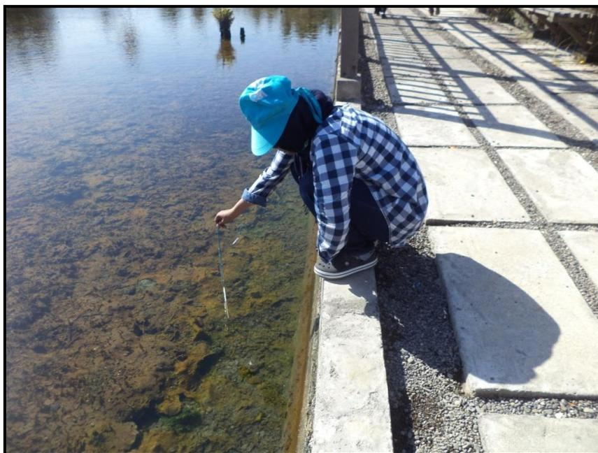
Gambar 2. Pengukuran Suhu Menggunakan Termometer pada Stasiun 1, dengan suhu 45°C dan difoto ke Arah Barat Laut (N315°E)
