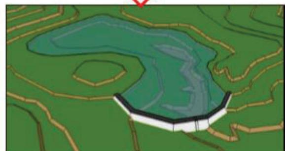
**Gambar 13.** Tinggi Tanggul Tambahan Embung Kondisi Optimasi Kapasitas
