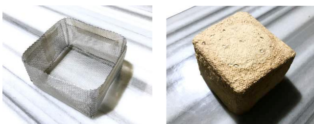
Gambar 8. Proses eksperimen dan hasil teknik Molding cetakan saringan
