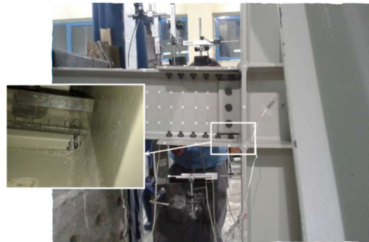
(a) Pergeseran sayap balok akibat slip baut di akhir pengetesan [8].
