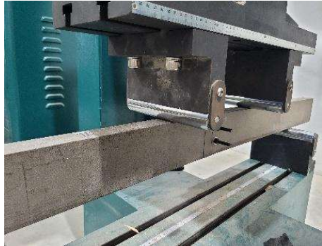
Gambar 7. Pengujian 2 Titik dengan UTM
