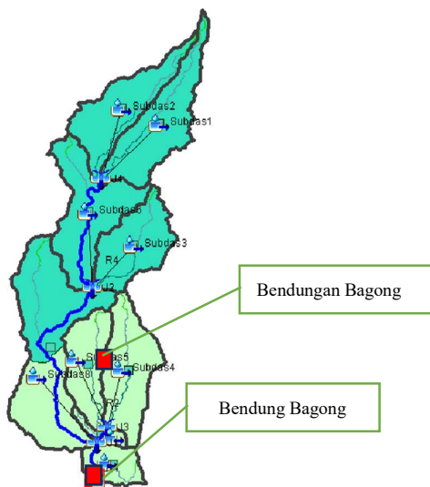
Gambar 1. Pembagian Sub DTA Bendung Bagong
