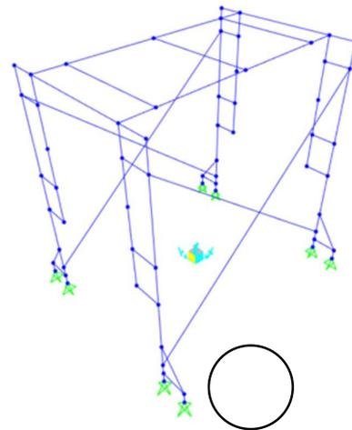
**Gambar 3.** *Scaffolding* 1 lantai dengan *outrigger* 1 sisi
