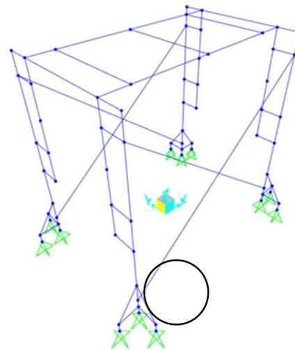
**Gambar 4.** *Scaffolding* 1 lantai dengan *outrigger* 2 sisi
