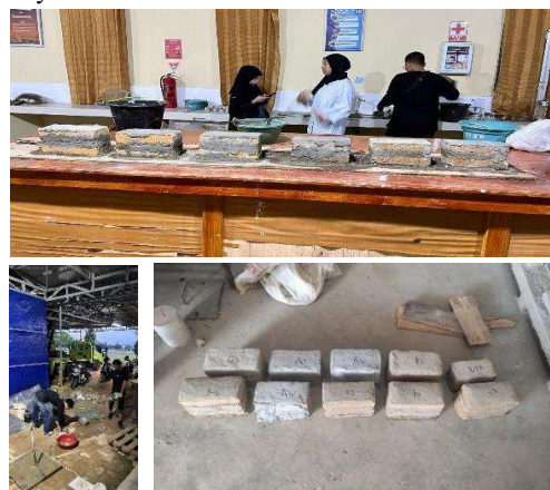
Gambar 4 . Sampel bata sebelum uji Kuat Tekan
