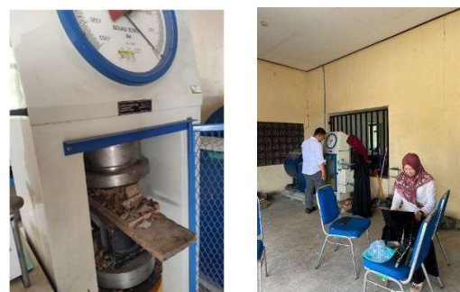
Gambar 5. Pengujian kuat tekan batu bata dengan mesin CTM.
