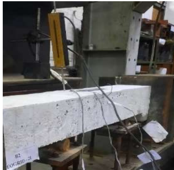
Gambar 10. Pola Retak Spesimen Kolom B2-2L
