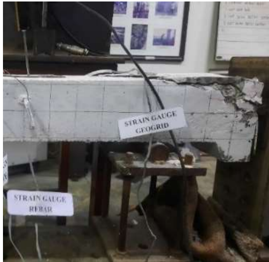
Gambar 6. Pola Retak Spesimen Kolom A1-1L
