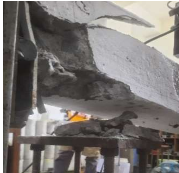
Gambar 8. Pola Retak Spesimen Kolom BNC
