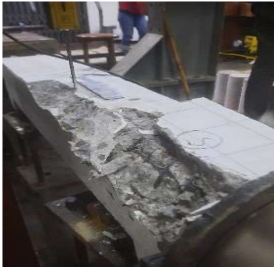
Gambar 9. Pola Retak Spesimen Kolom B1-1L
