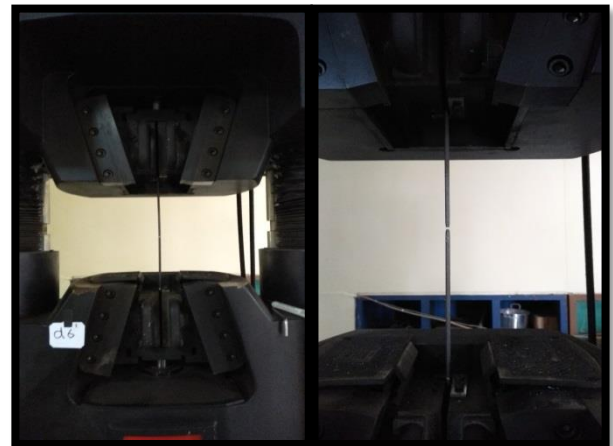
Gambar 2. Pengujian Kuat Tarik Baja
