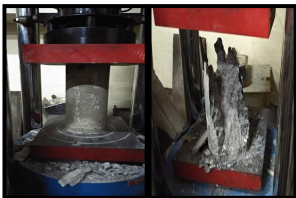
Gambar 1. Pengujian Kuat Tekan
