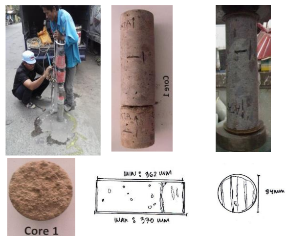
Gambar 3. Pelaksanaan Core Drill di Lapangan Lokasi 1 Sumber: Dokumentasi Peneliti
