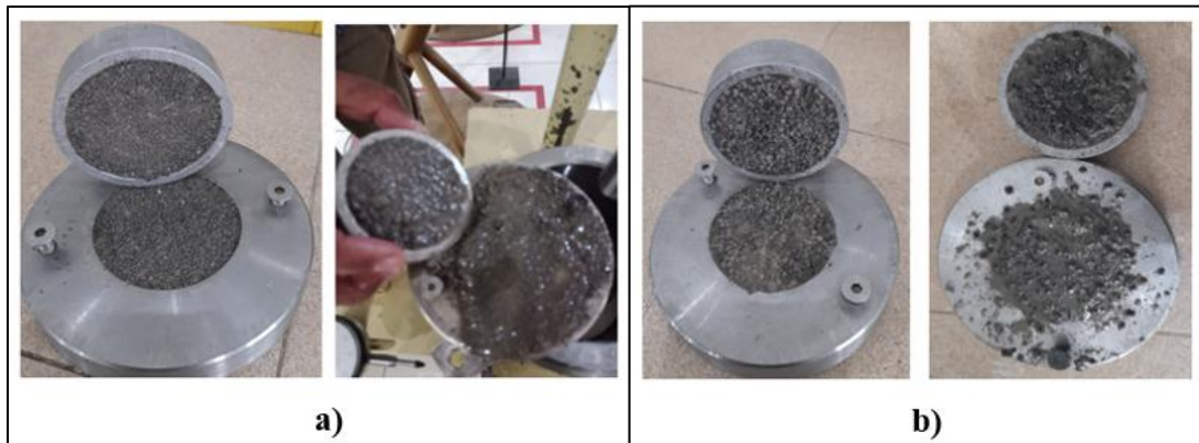
Gambar 7. Benda uji konsistensi very stiff sebelum dan setelah diuji (a) kekasaran medium (b) kekasaran kasar
