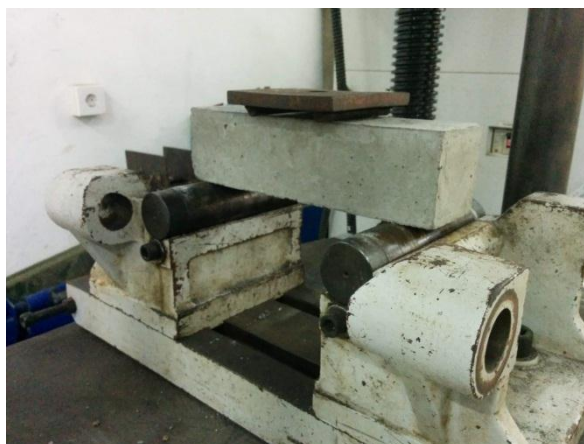
Gambar 4. Pengujian Kuat Lentur Balok Beton
