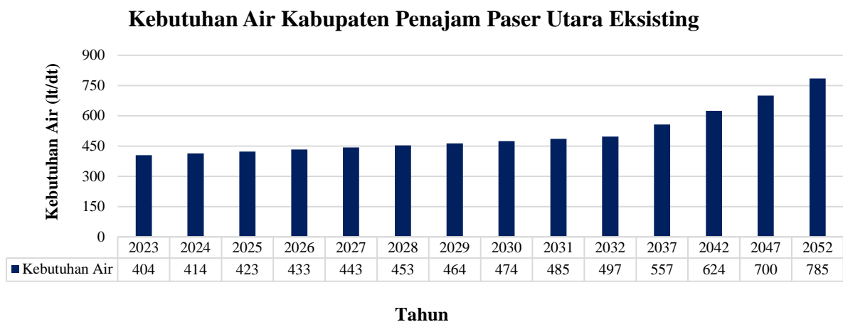
Gambar 2. Grafik Jumlah Kebutuhan Air Baku Kabupaten PPU Eksisting (IKN tidak dipindahkan)
